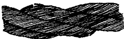
Рисунок 1. Обрывы и смещения проволок каната крестовой свивки
